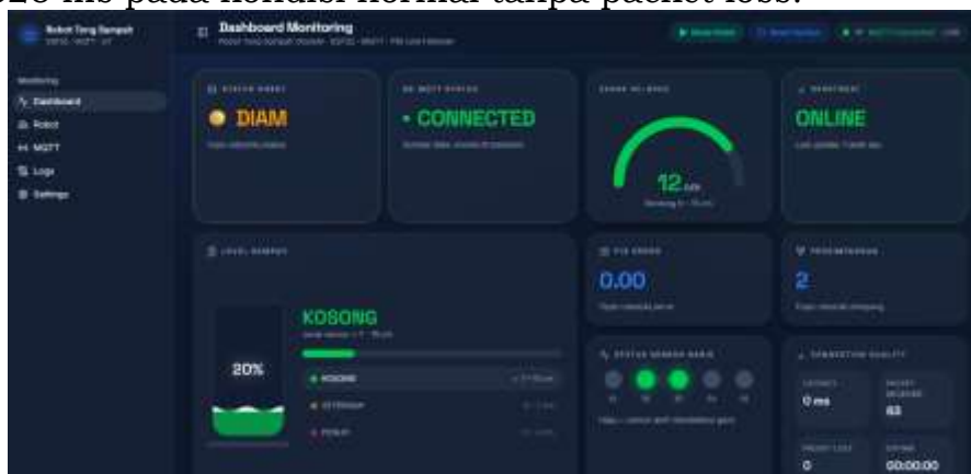
Gambar 4 Tampilan Dashboard Monitoring Next.js – Menampilkan gauge chart jarak HC-SR04, indikator status Kosong/Setengah/Penuh, grafik PID error, dan status online IoT)
