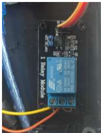
Gambar 4 Modul Relay sebagai Pengendali Pompa Air
